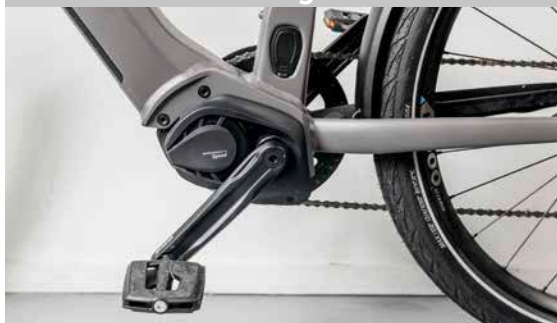
Bon équilibre grâce au moteur placé au centre de gravité
